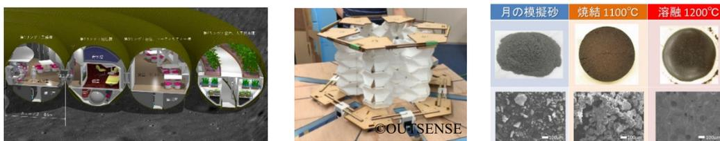
図 11：インフレータブル構造のイメージ図（左図）と展開構造の模型（中央図）、月模擬砂を用いた建材（右図）
