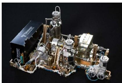
図 10：月面用水電解装置 外観
